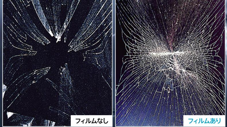
**優れた飛散防止性能を実証。ガラス飛散による二次災害を低減します。**
